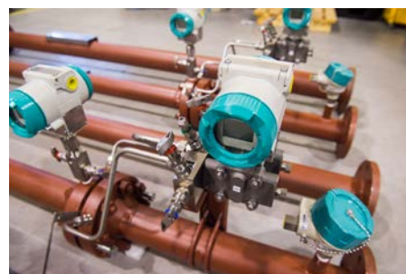
Fig 4 : panoplie Siemens (capteur de pression statique, capteur de température, transmetteur de pression différentielle)
