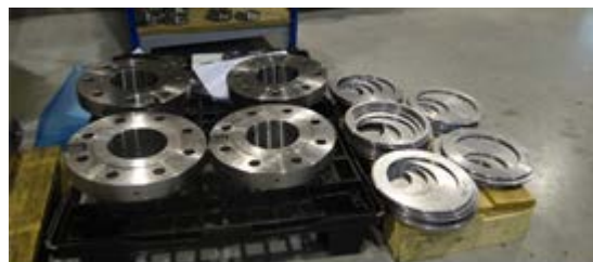
Fig 1 : brides de raccordement et plaques pour les différents étages
