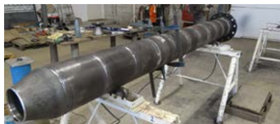
Fig 2 : fabrication en cours pour l'orifice de restriction 11 étages
