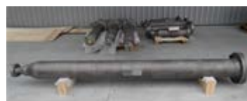
Fig 3 : limiteurs de débit en attente d'emballage
